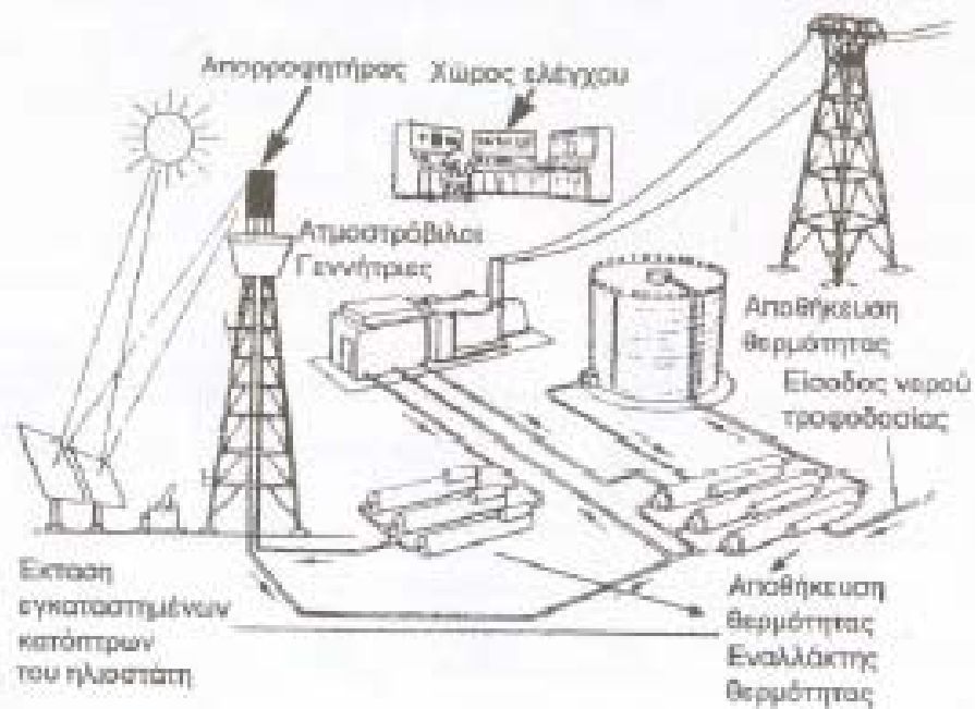
Μία άποψη ενός σταθμού ηλιοστάτη. Παράγει ενέργεια 10 MWe
