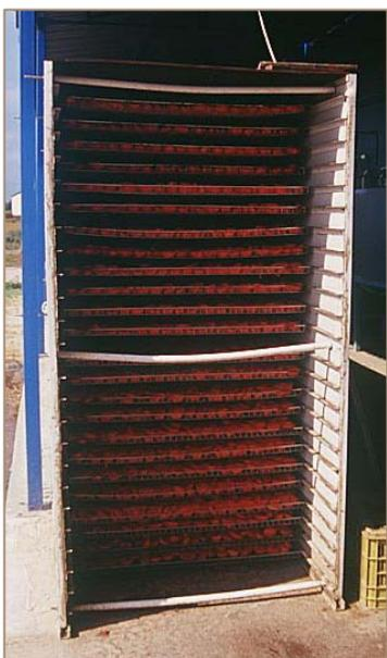
Σχήμα 55: Γεωθερμικό ξηραντήριο τομάτας τύπου σήραγγας στο Ν. Εράσμιο της Ξάνθης
