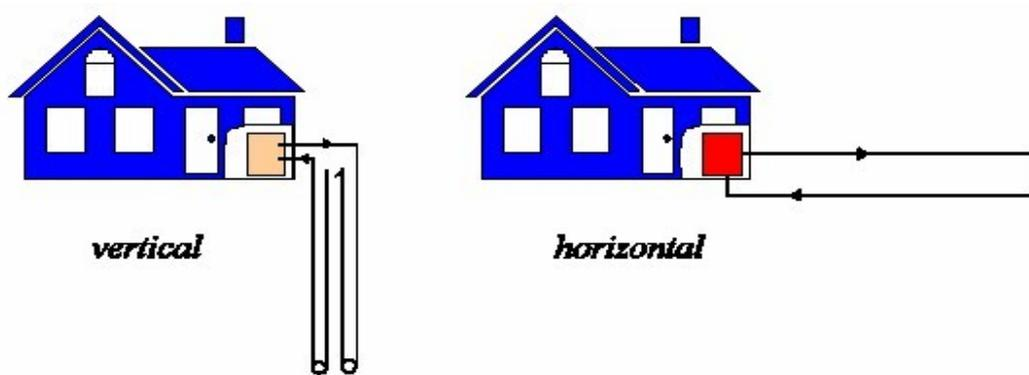
Σχήμα 58: GCHP, Κλειστά συστήματα, κατακόρυφο και οριζόντιο
