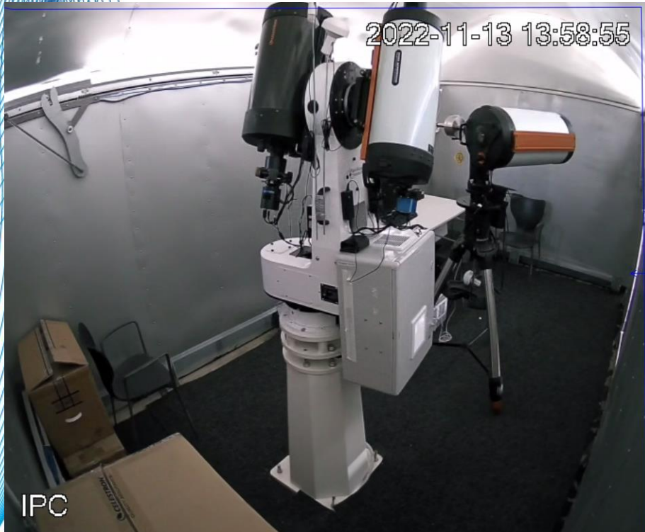
Ευθυγραμμισμένα τηλεσκόπια 30cm f/6 (tracking) και 28cm f/2.2 (survey)
