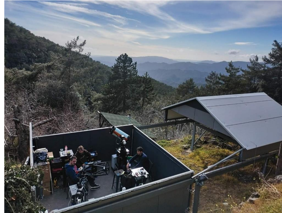
Εγκατάσταση του τηλεσκοπίου 30cm - f/2.2 στη SPICA (Πρόδρομος)
